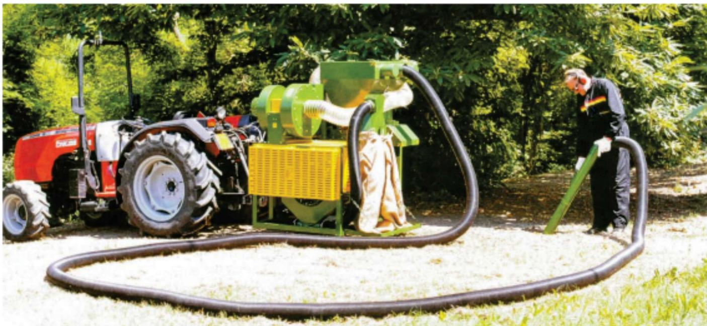
A máquina pode ser utilizada seja na recolha de avelã, utilizando o ciclone anti poeira e o rolo selecionador com furo diâmetro 26mm, seja na recolha da castanha (normalmente sem ciclone) utilizando um rolo selecionador com furo de 45mm de diâmetro. O notável comprimento do tubo flexível de aspiração facilita o ajuntamento do produto a recolher mesmo em zonas dificeis.
