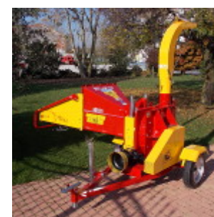
Cippatore con carrello e tramoggia ruotata di 90°
